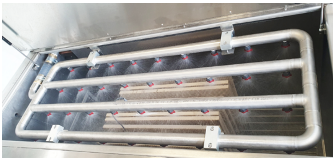
Sistema di spruzzatura - Sprayng system
